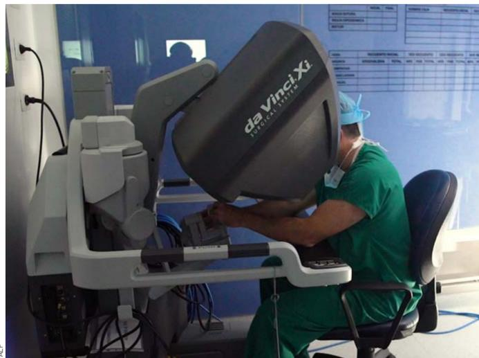
El cirujano mueve los brazos del robot, observando el interior de un paciente por un visor. El robot ejecuta con precisión esos movimientos enviados desde la consola (abajo).
